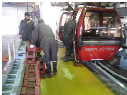
(荷重制動試験時のウェイト積み込み)
