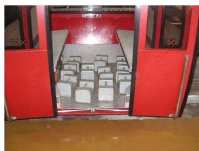
(荷重制動試験時のウェイト積み込み)
